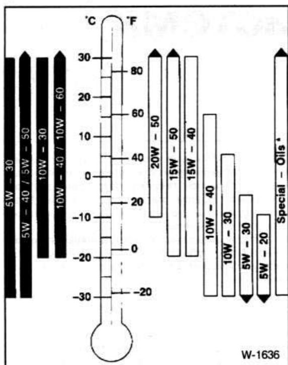
Черным выделены масла для дизельных двигателей, белым — масла для бензиновых двигателей. Так как диапазоны применения масел соседних классов SAE перекрываются, кратковременные изменения температуры можно не учитывать. Допускается смешивание масел различных классов вязкости при доливке, когда окружающая температура уже не соответствует вязкости масла, залитого в двигатель.
