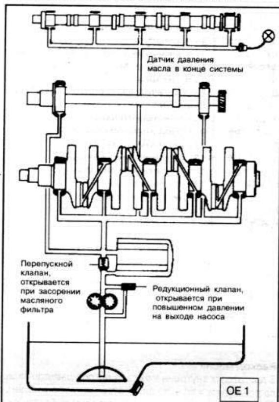
При работе двигателя масло из поддона картера засасывается через маслоприемник шестеренным масляным насосом и подается в масляный фильтр. На выходе масляного насоса установлен редукционный клапан, который открывается при излишнем давлении и позволяет части масла стекать обратно в масляный поддон.
